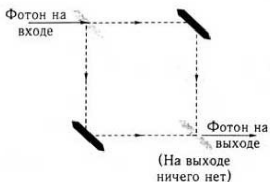
Рис. 9.3. Один фотон, проходящий через интерферометр. Положение зеркал (обычные зеркала показаны черным цветом, полусеребряные – серым) можно отрегулировать так, что интерференция между двумя разновидностями фотона (из разных вселенных) заставляет обе разновидности двигаться к выходу по одной и той же траектории от нижнего полупрозрачного зеркала
